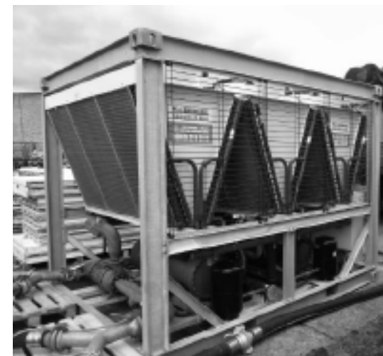
Fig. 6 In condizioni di funzionamento normali, la temperatura di mandata viene visualizzata sul display. Il motore della ventola situata in cima all'unità funzionerà solamente quando deve rimuovere il calore dalla serpentina di condensazione.
