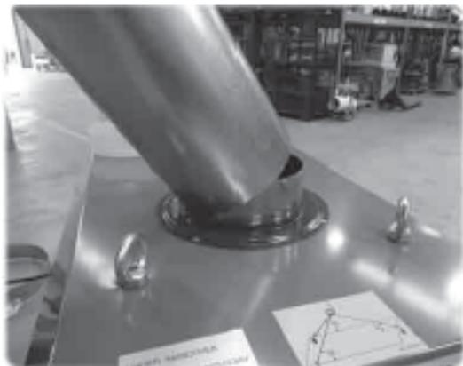
Montare il condotto flessibile sul davanti della macchina. Lunghezza massima 40 metri x 450 mm di diametro.
