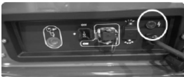
Se il riscaldatore esaurisce il carburante, la spia di blocco si accende. Rifornire il serbatoio e premere il pulsante di riavvio.
