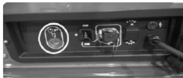
Portare l'interruttore di riscaldamento / ventilazione in posizione "riscaldamento". Il bruciatore si accende.
