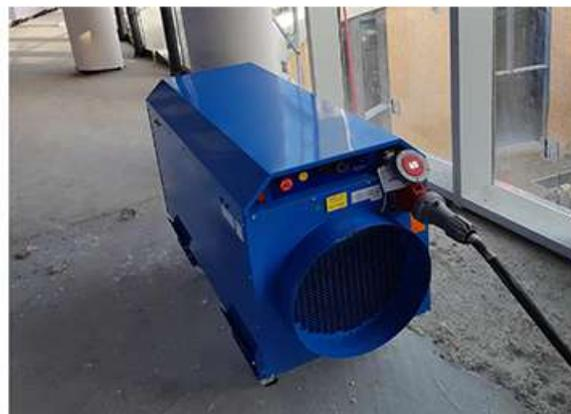
Capacità di riscaldamento nominale 383 kW
